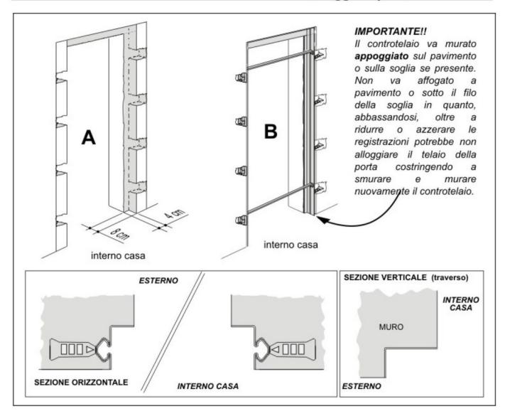
Nella figura A è esemplificato l'ingombro utile necessario all'installazione del controtelaio lasciando una mazzetta sui tre lati di 8 x 4 cm circa e tenendo conto delle nicchie che dovranno alloggiare le zanche.
