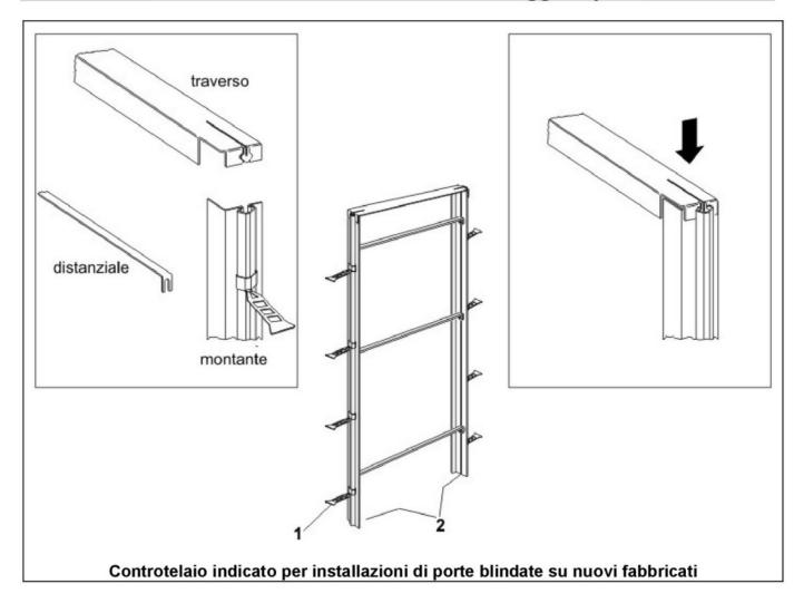
Assemblare il controtelaio a gola come indicato in figura. Il traverso va manualmente unito ad incastro con i montanti come indicato dalla freccia, quindi si collegano tra loro i montanti con i distanziali in dotazione.
