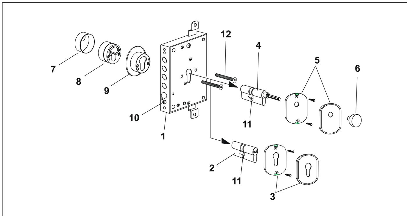
Il disegno indica in primo piano la sequenza di fissaggio di un cilindro (chiave-chiave) alla serratura (in secondo piano la stessa sequenza è riferita ad un cilindro chiave-pomolo).
